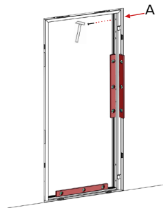
Fig. 15. Installing the anchor bolt.
